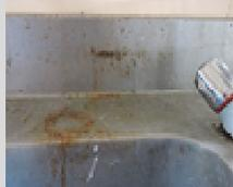
L'action du **dérouillant neutre** sur l'acier inoxydable est visible par l'apparition d'une coloration rouge
